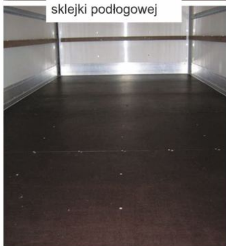
Gotowe zastosowanie sklejki podłogowej
